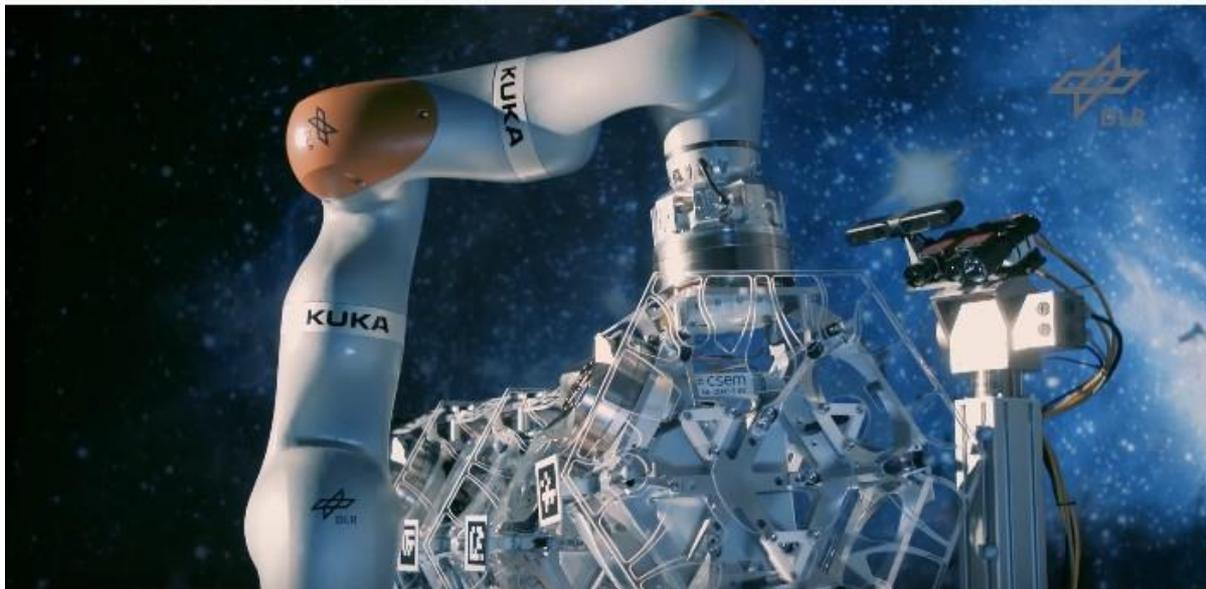
« L'idée est à terme de pouvoir assembler un miroir d'un diamètre de 35 mètres, avec beaucoup plus de tuiles », explique Julien Rouvinet, ingénieur au CSEM. « Cela n'a toutefois pas de sens de s'exercer sur ces dimensions, car le poids de la structure, qui représente un problème sur Terre, n'en est pas un, une fois en orbite ».
